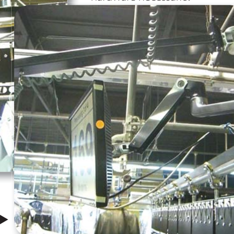
Mostra um Kit Scanner inclui o braço superior giratório, balanceador de ferramenta, scanner mão livre com 51cm de cabo e hardware necessário.
